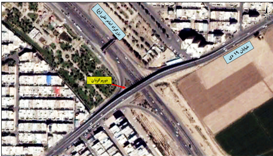
شکل ۴-۲۳ تقاطع شماره هفت، محل اتصال بزرگراه امام علی (ع) به خیابان ۱۹ دی به صورت تقاطع غیرهمسطح
