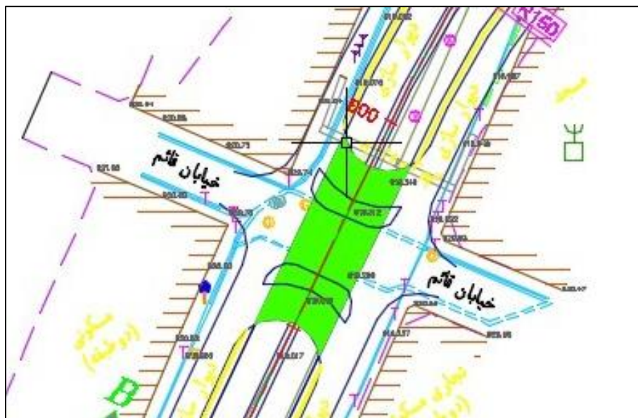
شکل ۵۶۵. طرح تقاطع زیرگذر شهرک قائم (عج)-بلوار کبیری
