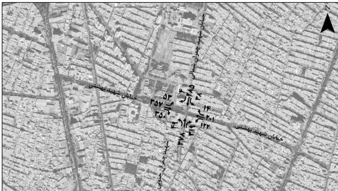
شکل ۶۹. حجم تردد همسنگ سواری در ساعت اوج در حوزه نفوذ تقاطع شهید بهشتی و شهید چمران
