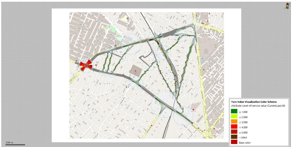
شکل ۳-۱۴۷ - سطح سرویس گلوگاه ها و تقاطعات شبکه معابر (خروجی شبیه ساز VISSIM 2020)
